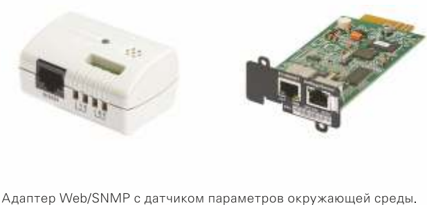
Адаптер Web/SNMP с датчиком параметров окружающей среды.
