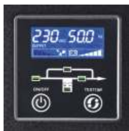
LCD дисплей для четкого отображения статуса работы ИБП и измерений
